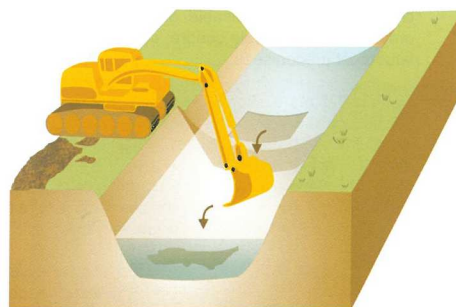
Figure 2 : Réensemencement à la pelle mécanique de la zone curée par épandage de la crème de la vase ancienne Source : Des Touches H. et Anras L., 2005.
